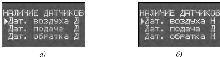
Рисунок 14.42 – Раздел Блокировка: а – все датчики активны; б – датчики воздуха и обратки заблокированы
